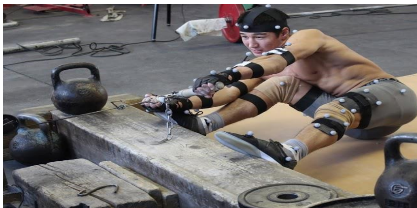
Рис. 7. Проведение видеосъемки выполнения тяги спортсменом В-м А. на модифицированном тренажере «Нижняя тяга» с применением “QualisysSystems”
